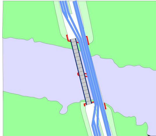
Variante 2: Einsatz einer System- Behelfsbrücke
