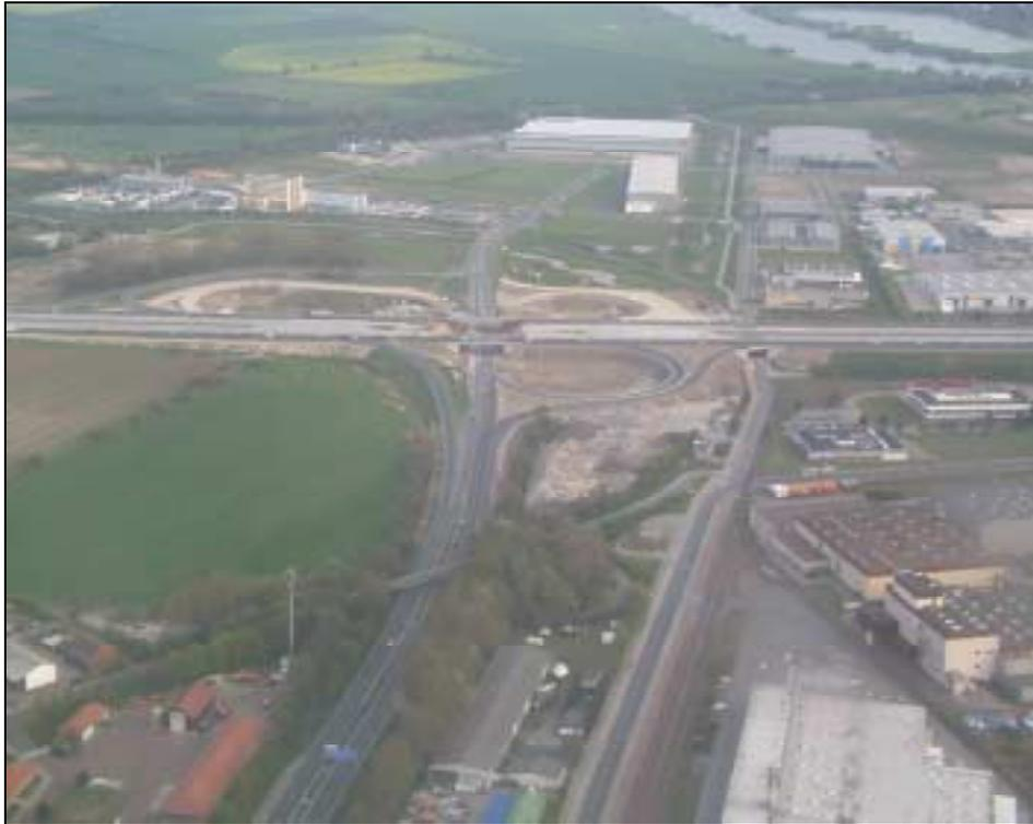
Der zweite Bauabschnitt sieht die Umlegung der Verkehre von den alten Hauptspuren der vorhandenen Bauwerke auf die neuen Verflechtungsspuren vor. Das alte Bauwerk wird dann abgerissen und durch zwei neue Bauwerke ersetzt. Dies ist für 2004 geplant.
