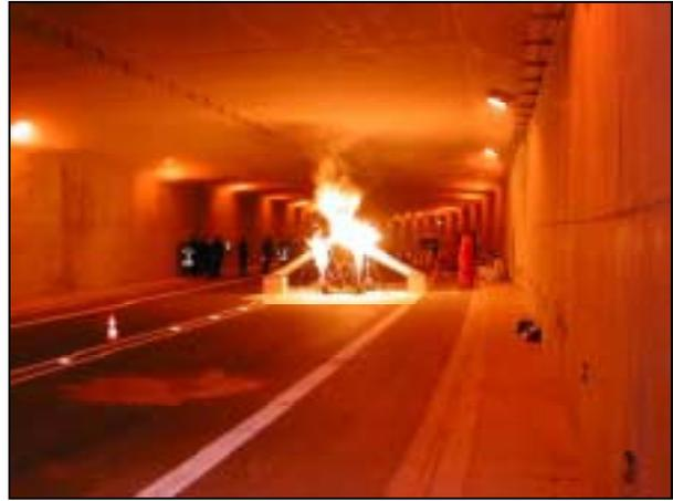
Brandversuch im Tunnel
